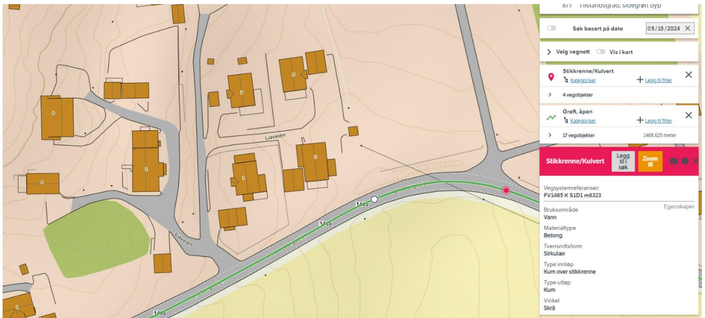
Figur 13 – Skjermbilde fra vegkart.no som viser stikkrenne og åpengrøft. Stikkrennen er kun vist som prikk i veien, ikke hvor innløp og utløp er. Informasjonsboksen om stikkrennen tilhører den som er vist med hvit prikk. (Kilde Statens vegvesen)
