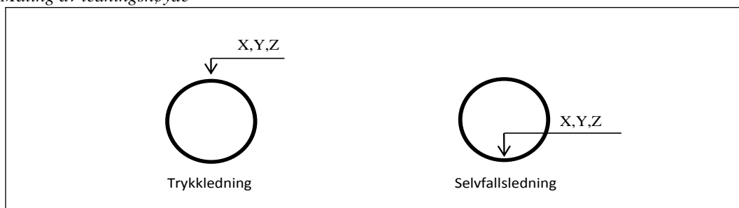
Figur 1 Måling av ledningshøyde
