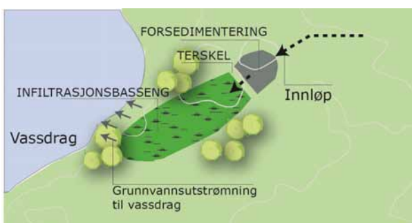
Prinsippskisse av åpent basseng for infiltrasjon i stedege masse (plan/snitt)
