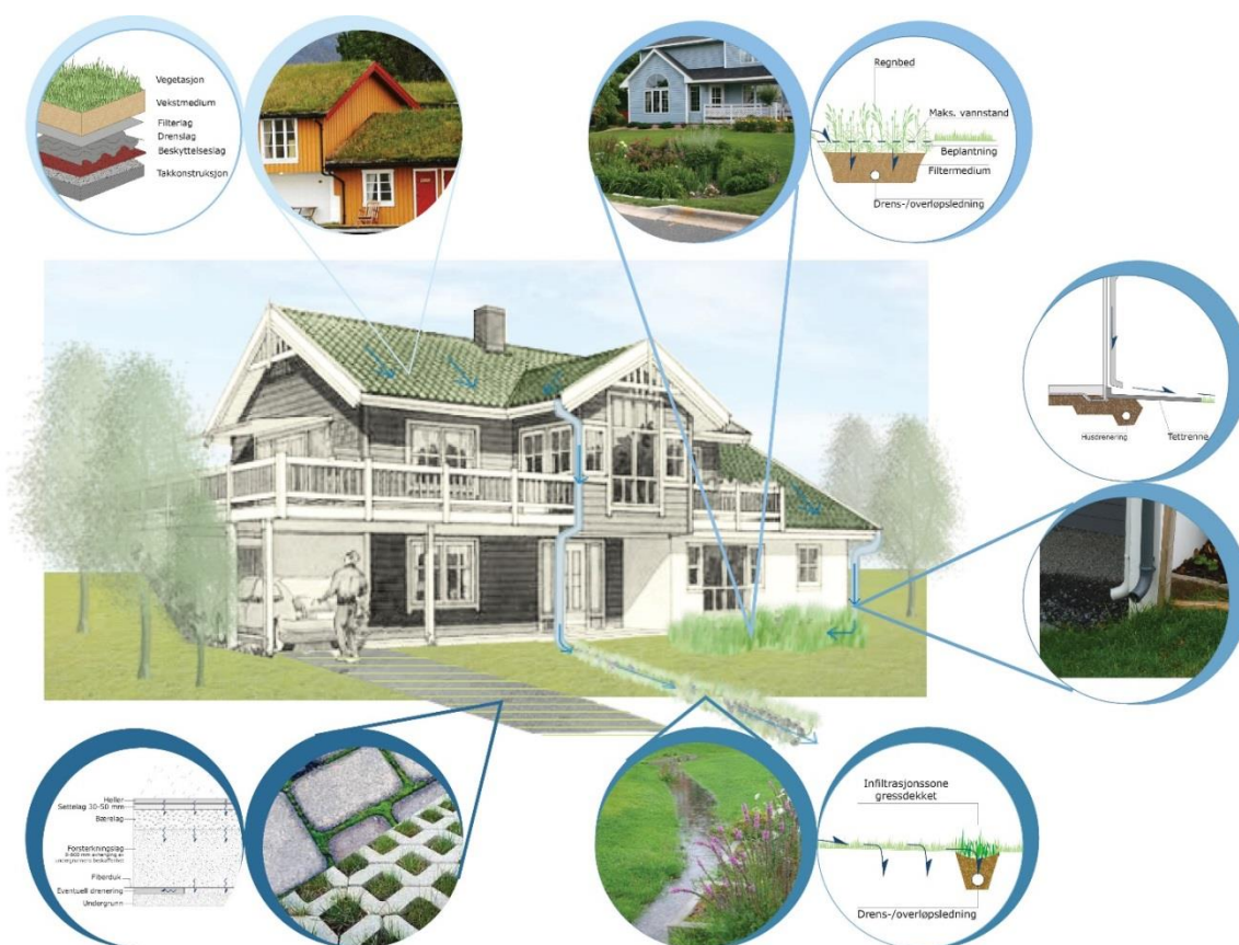
Figur 11: Oversikt over aktuelle overvannsløsninger i småhusbebyggelse (Illustrasjon: Cowi AS)
