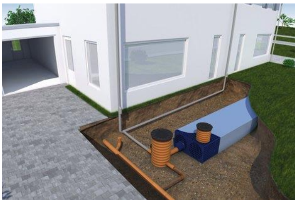
Figur 19: Løsningsforslag med fordryning i overvannskassetter, som kan TV-inspiseres og spyles. (Illustrasjon: Leverandør)
