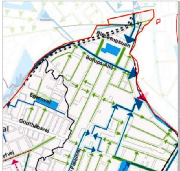
Skybruddsplan for delområde i København. Skybruddsplanen for dette området bygger på lokal infiltrasjon, forsinkelse og transport av vann i grønne veier (grønne linjer), etablering av skybruddsveier for transport av vann (blå linjer), skybruddsmagasiner (blå felter) og en skybruddstunnel for sluttavledning av vannet til havnen (rød linje). Figur: København kommune
